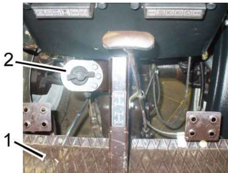
Рисунок 2.7.1 Выключатель АКБ 1 – площадка для ног; 2 – выключатель АКБ
