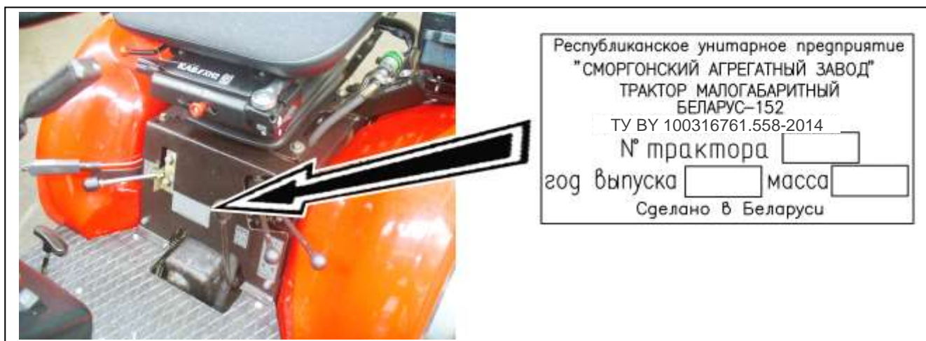
Рисунок 1.5.1 – Место расположения фирменной маркировочной таблички трактора
