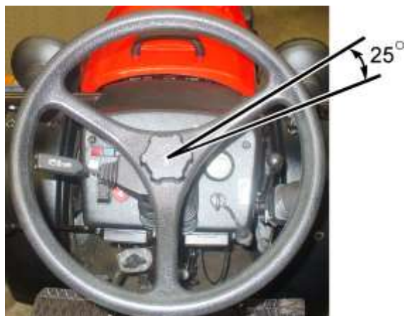
Рисунок 6.4.8 – Проверка люфта рулевого колеса
