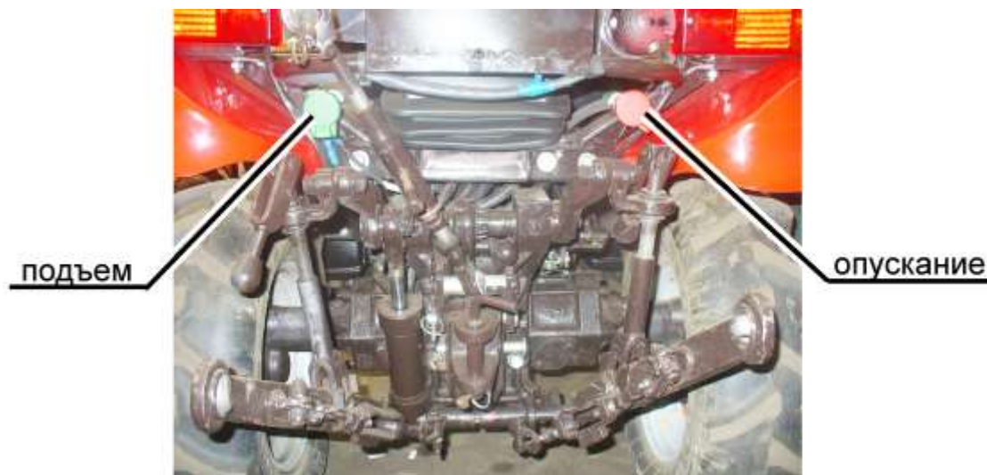
Рисунок 2.14.2 – Схема расположения и подключения выводов распределителя к внешним потребителям
