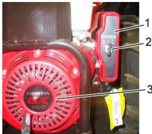
1 – пульт; 2 – выключатель стартера; 3 – двигатель
