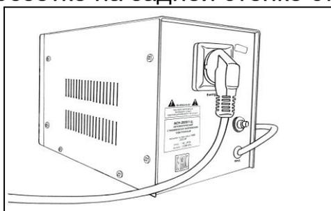
Рис. 5 Подключение нагрузки
