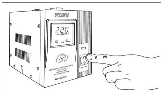
Рис. 3. Включение стабилизатора
