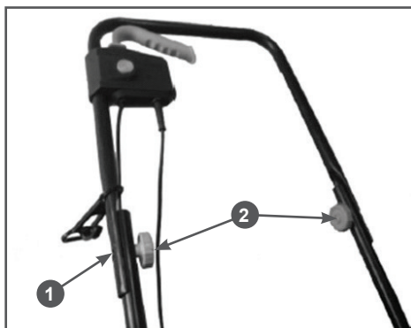
Рис. 5 Соединение верхней и нижней части рабочей рукоятки
